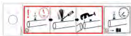
940 - Warnhinweis "Transportfüllung" am Schraderventil
